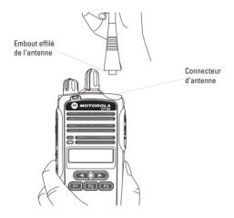
Pour installer l'antenne, fixez-la à la radio en plaçant l'embout fileté de l'antenne dans le connecteur d'antenne et faisant pivoter pour serrer à fond.
